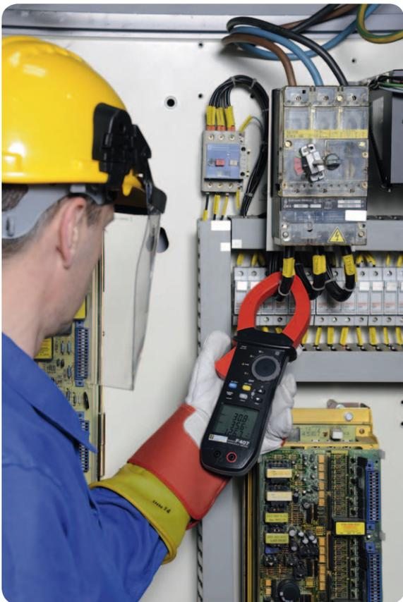
Mit **nur einer Hand** lassen sich die Leistungs- und Oberschwingungsmesszangen F407 und F607 bedienen: den Leiter einfach mit den Zangenbacken umschließen!
